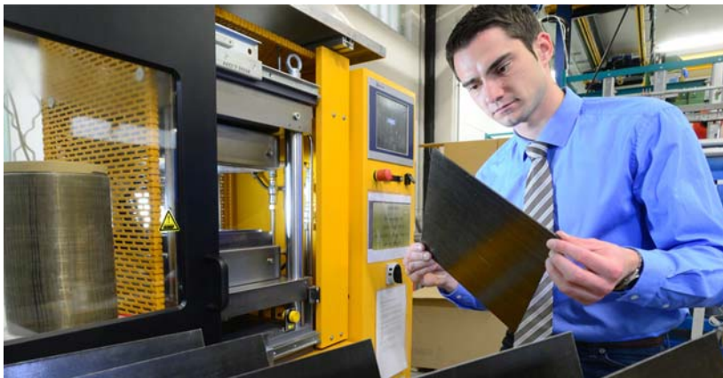
Cetex-Forschungsleiter Sebastian Nendel prüft die Qualität eines basaltfaserverstärkten Organoblechs. Das Institut beteiligt sich an den Arbeiten des vom Bundesministerium für Wirtschaft und Technologie geförderten BasaltFaserNetzwerk (siehe dazu auch 5) Foto: W. Schmidt
