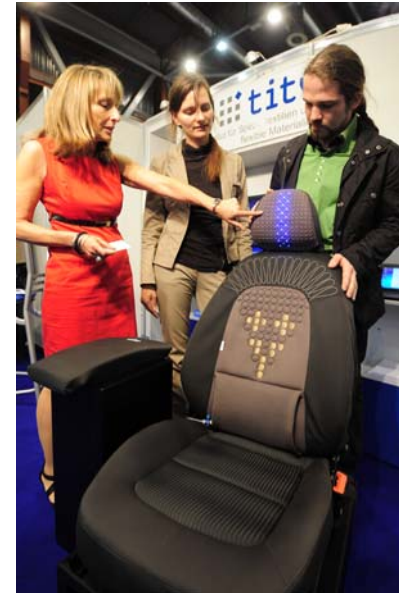
Das TITV präsentierte auf der diesjährigen mtex einen mit leitfähigen Textilien ausgerüsteten Autositz.
