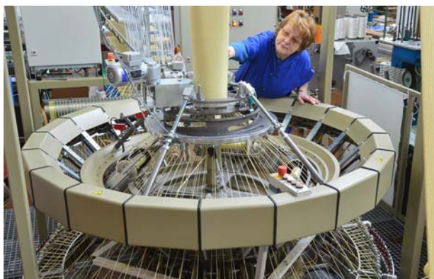
Foto links: Weberei-Meisterin Marion Hachmeister bedient im STFI Chemnitz einen Webautomaten des Herstellers Karl Mayer. Die Textilforscher haben die Maschine so modifiziert, dass darauf Rundgewebe mit veränderbarem Durchmesser gefertigt werden können. Foto rechts: Das von der Messe Frankfurt/M. veröffentlichte offizielle Preisträger-Foto.
