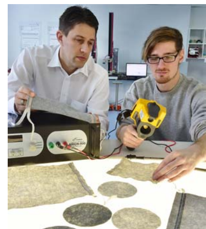
Im Entwicklungslabor von Norafin prüfen Geschäftsführer André Lang und Forschungsingenieur Tobias Thiem (v. l.) mit einer Wärmebildkamera die elektrisch beheizbaren Vliesstoffe. Foto: vti-pressdienst / W. Schmidt
