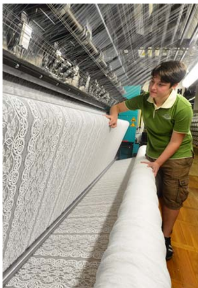
Hightech-Raschelmaschine zur Spitzenherstellung in der Spiga GmbH.
