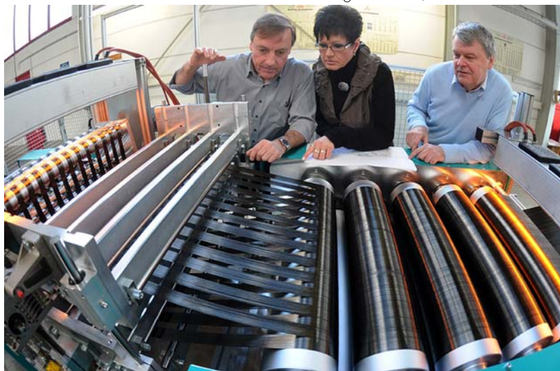
Gespannt verfolgen sie gemeinsam den Probelauf der neuen Faserspreizanlage zur Herstellung textiler Halbzeuge für Hightech-Leichtbauteile: (v. l.) Alexander Wegner von der Karl Mayer Malimo Textilmaschinenfabrik sowie Astrid Kirchberg und Frank Vettermann vom Cetex Institut. Foto: Wolfgang Schmidt
